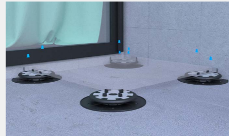
2° Remove the edge and corner spacers
